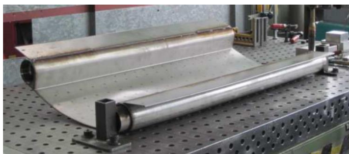
Échangeur installé dans un ovoïde existant (Rabtherm), échangeur pour collecteur existant (Uhrig) (Lyonnaise des eaux)
