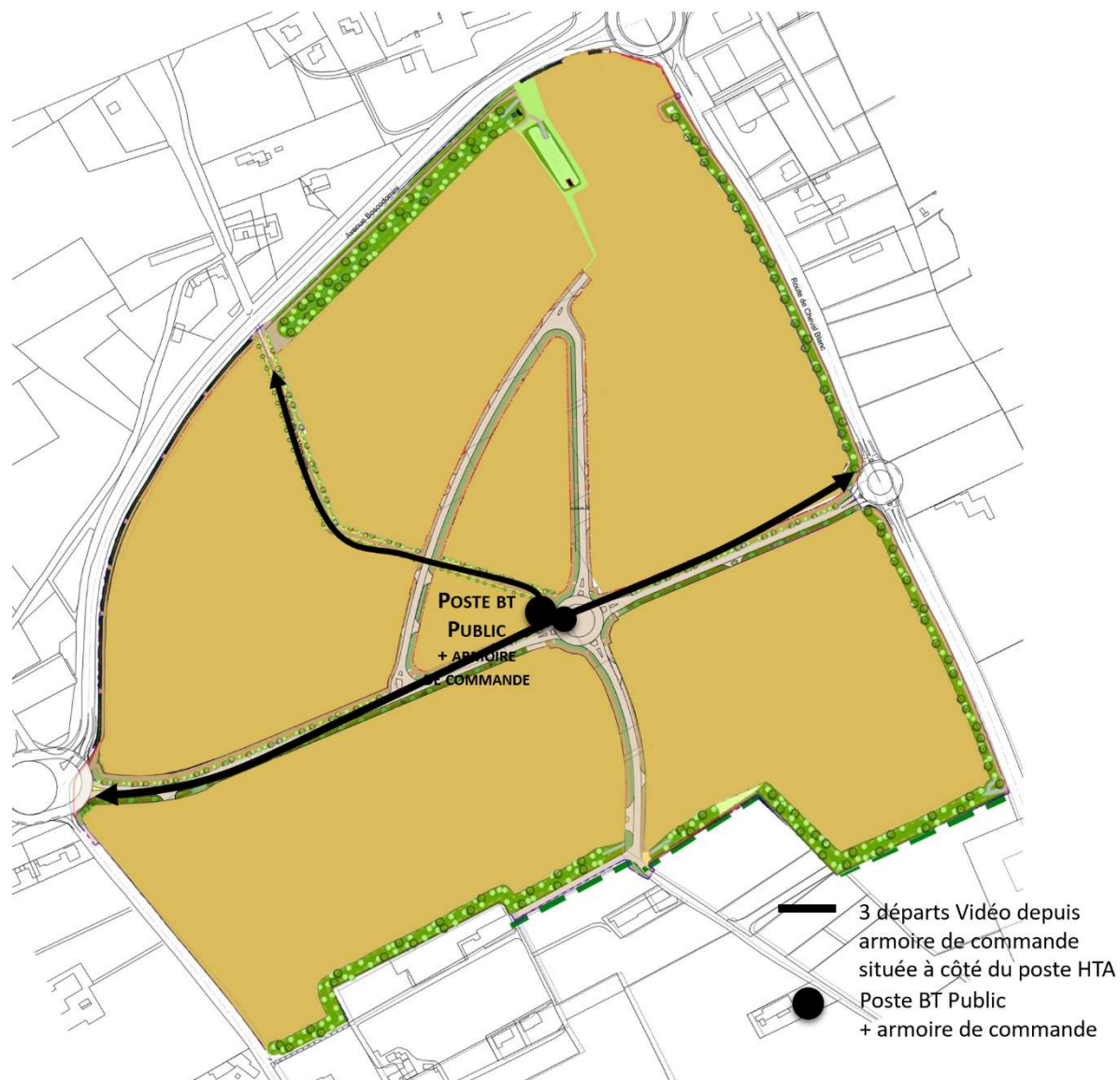
RESEAUX VIDEO / TELESURVEILLANCE – SCHEMA DE DESSERTE
