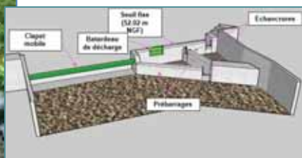
Etat initial et projet seuil aval (restauration du seuil, pose d'un clapet régulateur et mise en place d'une passe à poissons)
